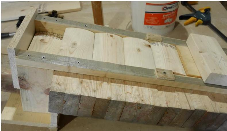
Vue du montage de test pour le comportement des lattes lorsque poussés dans une chute
